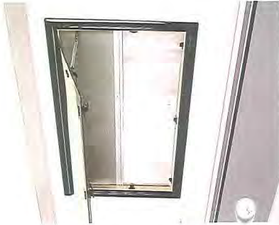
Serienmäßig doppelt verglaste Fenster, hier das Ausstellfenster Typ 625 mit Moskitogitter und Ventilatorfenster des Modellreihen 625. In der Ausstattungserie Alu-Fahrersei-
